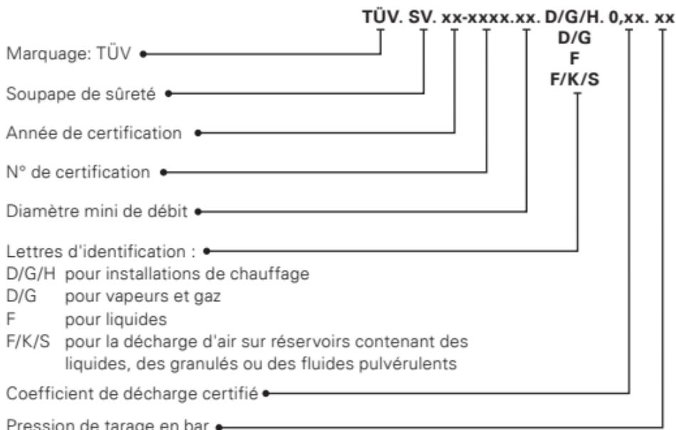
Nos soupapes de sécurité sont contrôlées quant à leur résistance à la pression et à leur étanchéité; elles sont réglées à la pression de tarage souhaitée et dotées d'un plombage. Le marquage est indiqué de façon indélébile sur une plaquette attachée à chaque appareil, ou sur le chapeau à ressort de la soupape. Sur la plaquette d'identification figurent de plus des marquages et informations techniques requises suivant la DIN EN ISO 4126-1.
